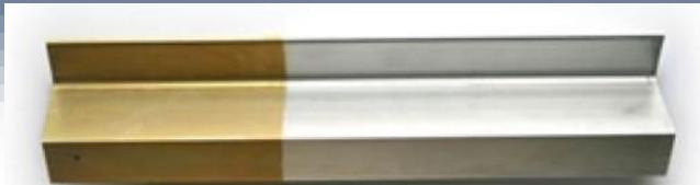
Местное химическое оксидирование алюминиевых сплавов
